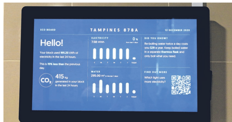
淡滨尼8道第878A座组屋的居民等候电梯时，可透过装在电梯旁的显示屏了解整座组屋的水电用量。（庄耿闻摄）
